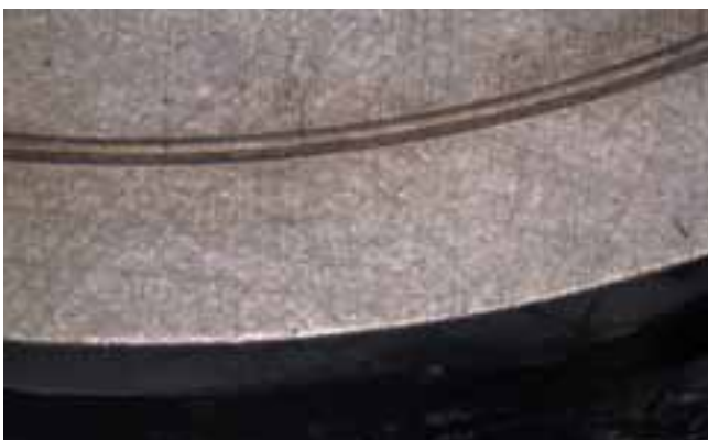
Einlaufrille nach 24 Stunden Run-in groove after 24 hours
